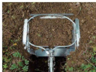
④ 木材の上に土を乗せてワイヤーを溝の中に納め落とし金具の爪にワイヤーを引っかける
